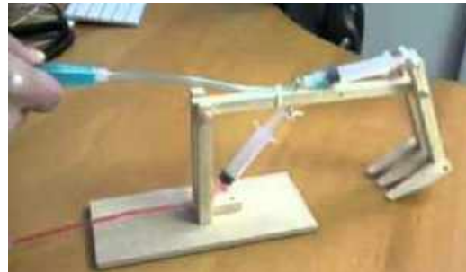
Görsel 4. Sıvı Basıncı ile Çalışan Kaldıraç Örneği (8. Sınıf Fen ve Teknoloji Ders Kitabı, 2012).
